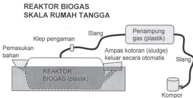
Gambar 1. Instalasi Reaktor Biogas Skala Rumah Tangga
